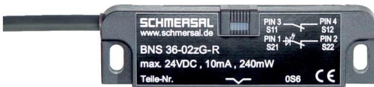
Tra le caratteristiche più interessanti del BNS36 spicca l'ampia isteresi del campo di lettura, con una distanza di attivazione sicura ( $s_{ao}$ ) ed una distanza di disattivazione sicura ( $s_{ar}$ ) che possono arrivare rispettivamente fino a 10 mm e 20 mm.
