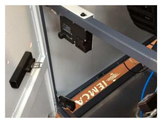
Il componente viene venduto in un'unica soluzione con il relativo azionatore, senza la possibilità di procurarsi un duplicato da parte dell'operatore. Si evita così che un comportamento errato ragionevolmente prevedibile possa in determinate circostanze essere causa di eventi che potrebbero mettere a rischio l'incolumità dell'uomo e l'integrità della macchina.
