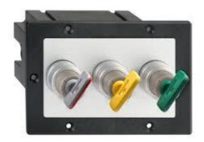
Le chiavi vengono rilasciate elettricamente mediante pilotaggio PLC e le chiavi rilasciate possono a loro volta ruotare dei selettori codificati che permettono manovre specifiche in condizioni specifiche.
