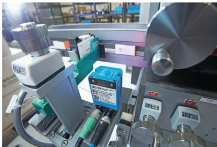
La tecnologia 4DPro di SICK permette al Lector62x di essere integrato con numerose reti industriali e, attraverso l'interfaccia Host, può inviare i dati di lettura ai dispositivi di livello superiore.
