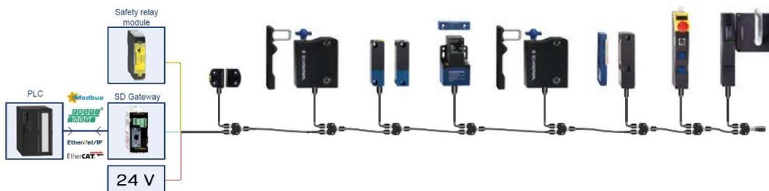
In tale architettura, il bus SD -*Serial Diagnostic*- di SCHMERSAL, consente di trasmettere su un unico cavo sia i segnali di sicurezza sia i segnali di diagnostica provenienti da ogni singolo dispositivo disposti in cascata.
