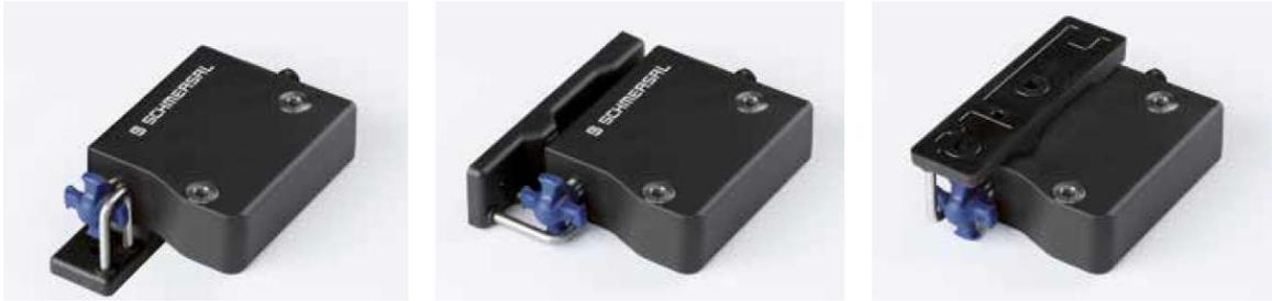
In prossimità del connettore, l'antenna RFID verifica l'accostamento dell'azionatore (in egual modo su tutti e tre i lati con cui questo può essere accoppiato). Questo controllo, che in ragione della tecnologia permette il riconoscimento individuale dell'azionatore, monitora il discostamento del riparo in seguito ad eventuale guasto nel sistema di tenuta.
